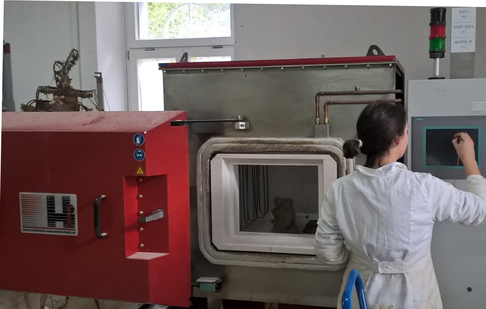
„Hofman HT1500.72“ - (Electric kiln)
